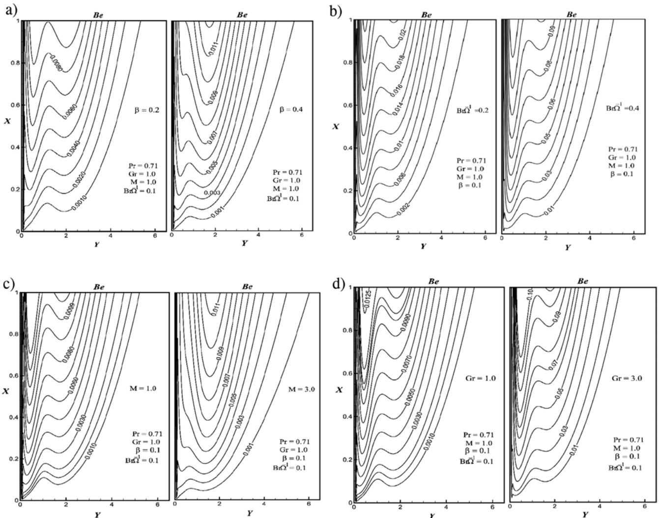
Fig. 12. Simulated steady-state Bejan lines ( $Be$ ) for distinct values of (a)  $\beta$ ; (b)  $Br\Omega^{-1}$ ; (c)  $M$ ; & (d)  $Gr$ .
