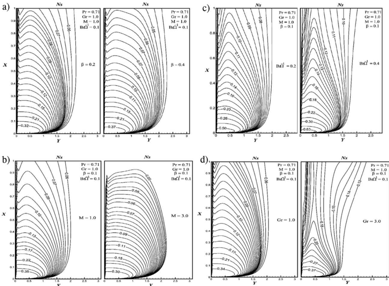
Fig. 10. Simulated steady-state entropy lines (Ns) for different values of (a)  $\beta$ ; (b)  $Br\Omega^{-1}$ ; (c)  $M$ ; & (d)  $Gr$ .
